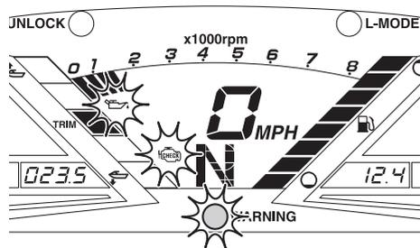
Αν ενεργοποιηθεί η προειδοποίηση πίεσης λαδιού, μειώστε αμέσως τις στροφές του κινητήρα, επιστρέψτε στην ακτή και ελέγξτε τη στάθμη λαδιού του κινητήρα. (Βλ. σελίδα 55 για πληροφορίες σχετικά με τον έλεγχο της στάθμης λαδιού του κινητήρα.) Εάν η στάθμη λαδιού υποδεικνύει επαρκή ποσότητα, απευθυνθείτε σε έναν αντιπρόσωπο της Yamaha για έλεγχο του υδροσκάφους.
